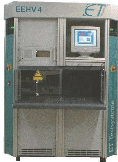
Sicherheitsstestsysteme EEHV 6 mit integrierter pneumatischer Haube
